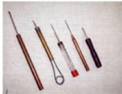
Для того чтобы изменить длину петли, применяются насадки для иглы. Их можно сделать из кусочка стержня шариковой ручки или изоляционной оболочки провода.
