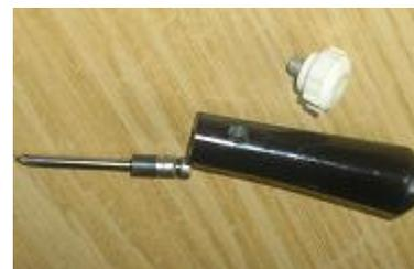
Инструмент в разобранном виде. Винт нужен для регулировки длины иглы и, соответственно, стежка. На конце иглы отверстие для нити, игла и ручка полые.
